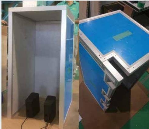
スピーカーを内部で後ろ向きに設置して、箱の正面から 1m 地点で簡易測定。開口なのにも関わらず、約 15dB の低減効果が得られました。
